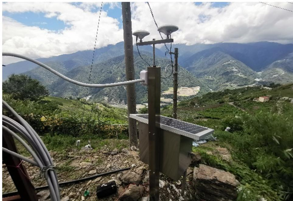
圖 3-11 雙頻 GPS 觀測站（含雨量計伸縮計及傾度盤）
