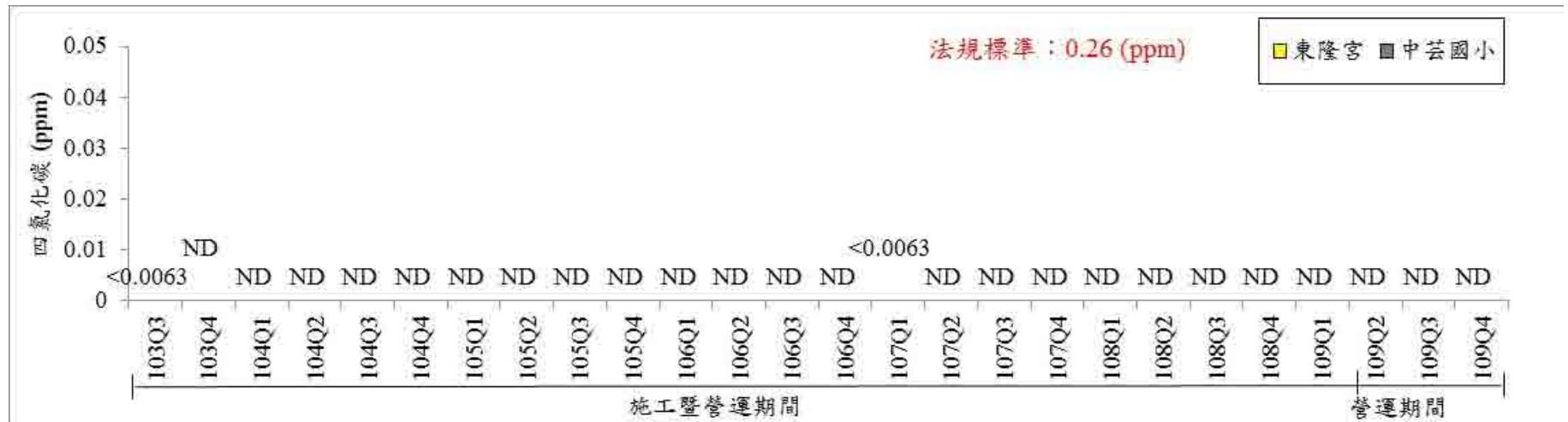
三輕更新擴產計畫歷次空氣品質-VOC 成分屬 HAPS 管制項目(四氯化碳)監測結果比較圖
