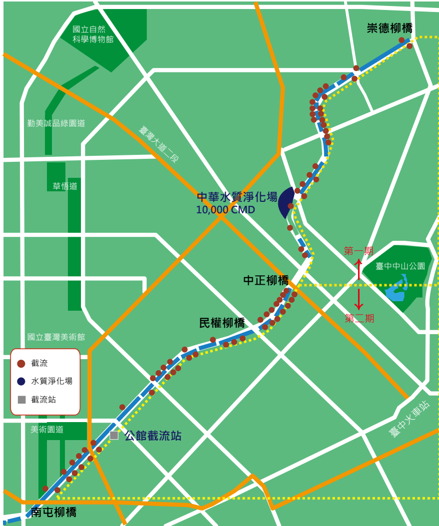
柳川污染整治及環境改善工程截流系統圖 / 吳建旺繪
