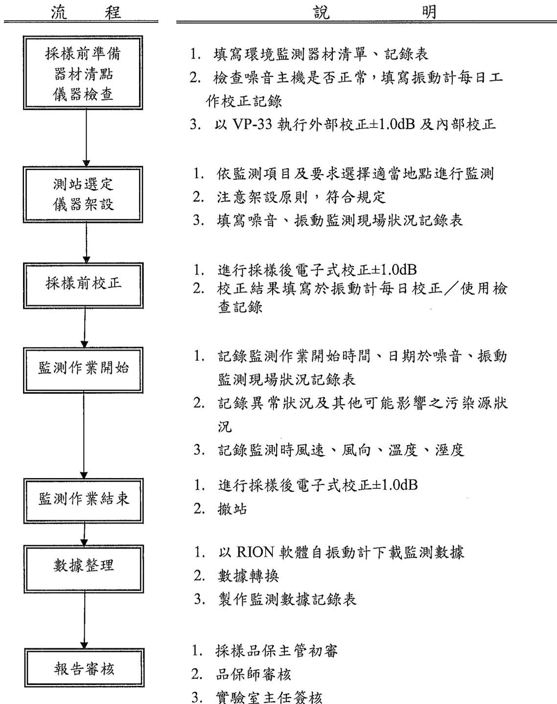
圖1-3 振動監測現場作業品保流程圖
