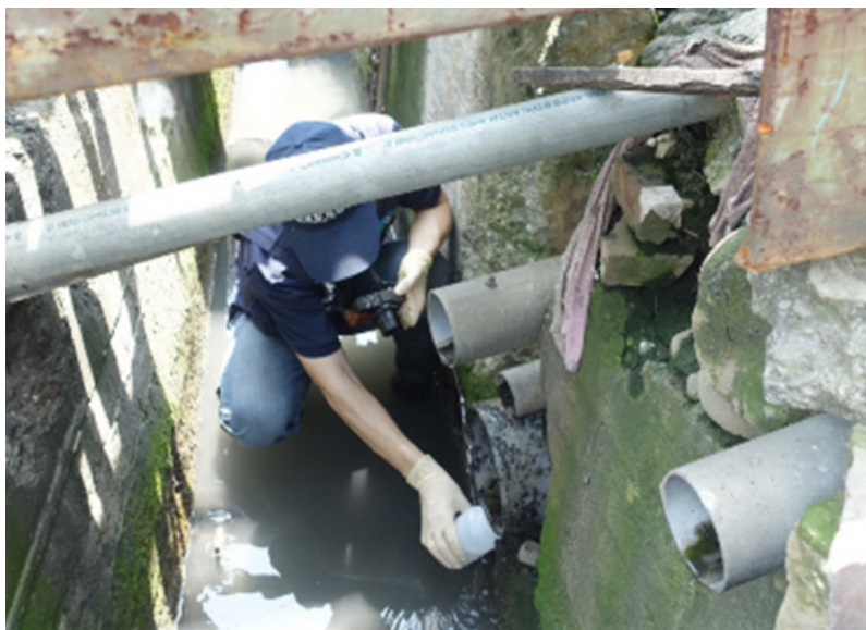
▶ 督察人員於事業雨水管進行廢水採樣檢測
