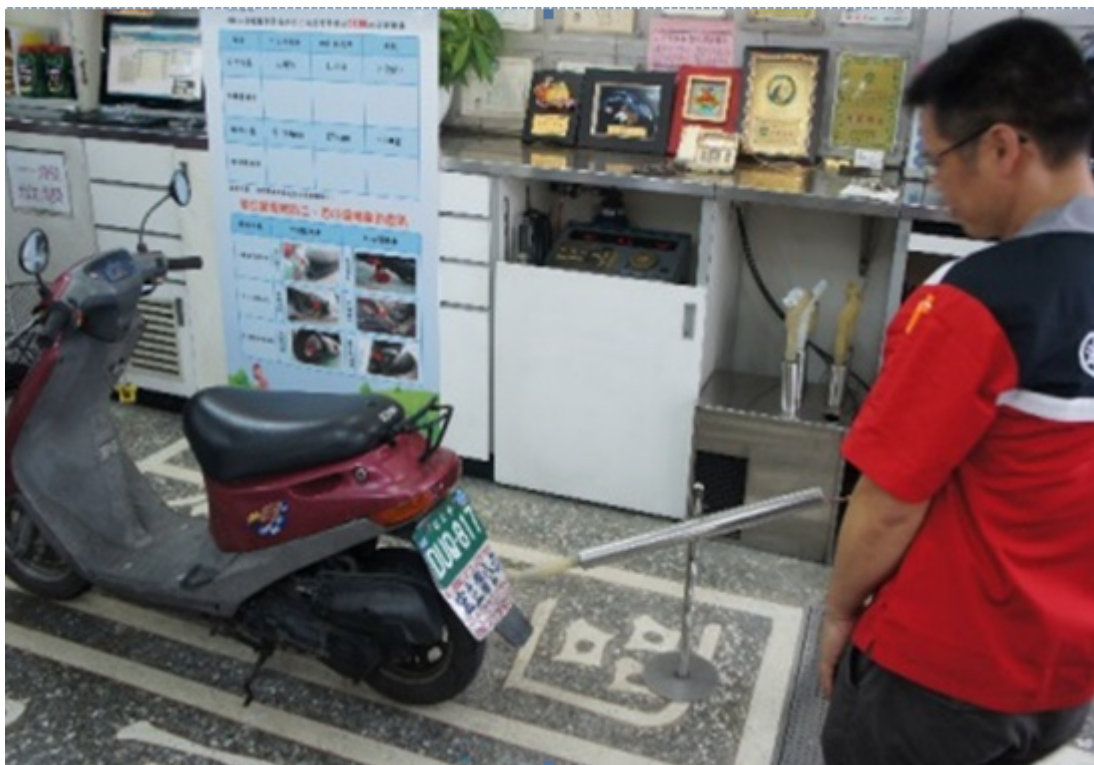
▶ 機車排氣檢驗站包含檢測區、電腦、排氣分析儀、標準氣體等設備。
