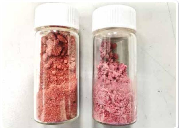
圖12-7 再製成硫酸鈷，含鈷量>23wt%
