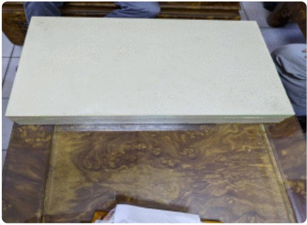
圖12-2 發泡打樣，添加15%改質後PUR粉
