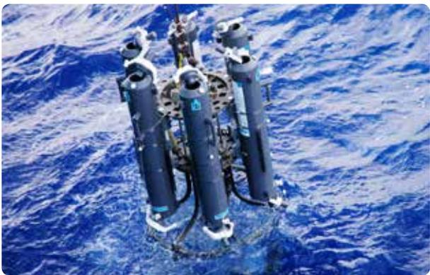
圖9-23 以CTD與採水瓶收集不同水層的水樣與水文資料
