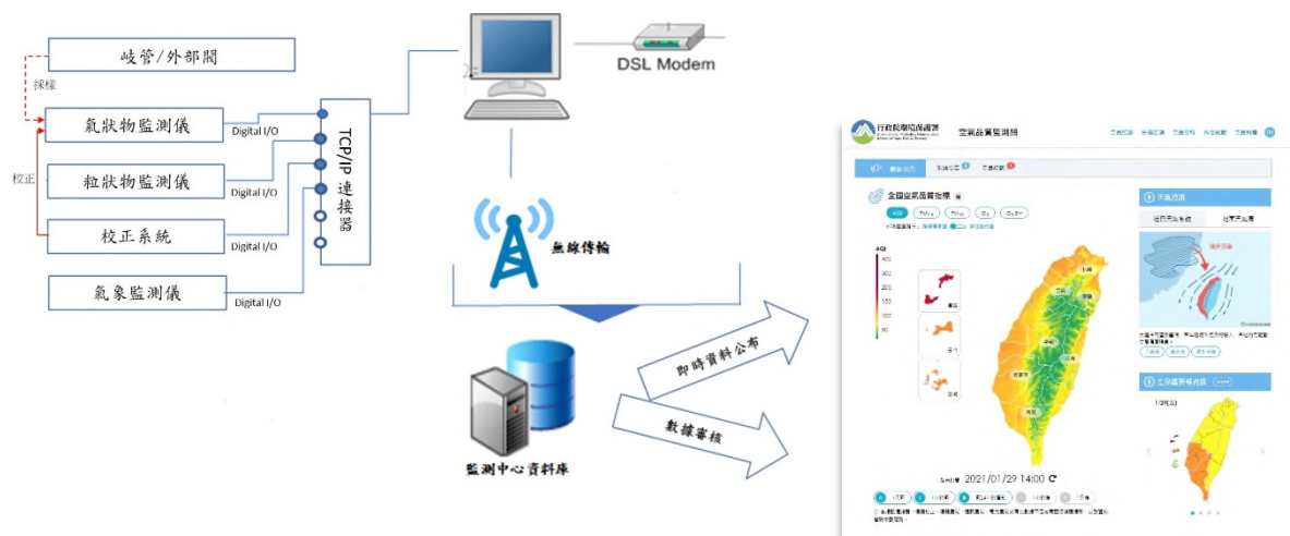
圖 2-1 空氣品質監測網資料傳輸流程圖
