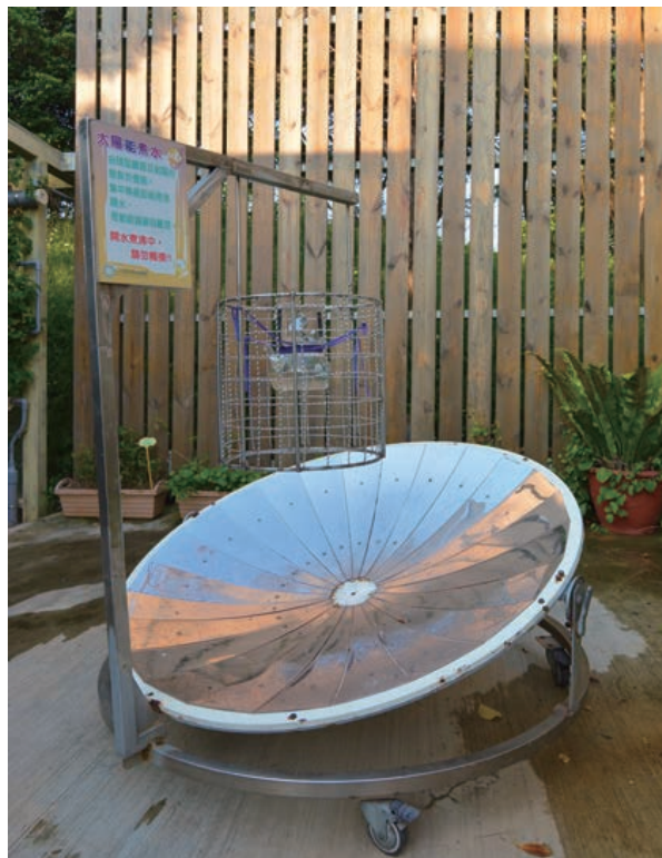
運用凹面鏡將太陽的光和熱聚集起來。
