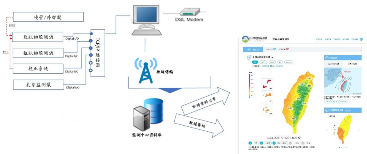
圖 2-1 空氣品質監測網資料傳輸流程圖
