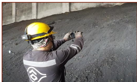
熱影像量測RDF表面溫度
