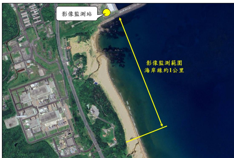
圖 3-16 數位影像監測系統站設置地點與監測範圍圖
