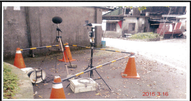
噪音振動監測情形 (104/3/16)
