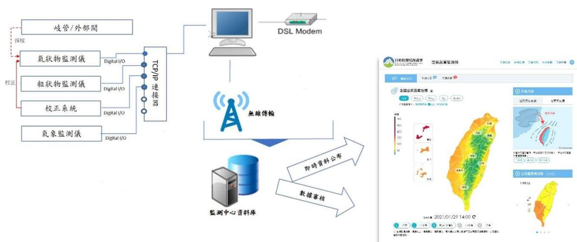
圖 2-1 空氣品質監測網資料傳輸流程圖
